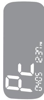
Die im CareSens N POP Blutzucker-Messgerät gespeicherten Messwerte können mit einem Datenkabel auf Ihren PC übertragen werden und dort mit der Software PC care / SmartLog ausgewertet und betrachtet werden. 'Pc' erscheint auf dem Display, wenn das Gerät per Datenkabel an einen Computer angeschlossen ist. Für weitere Informationen kontaktieren Sie bitte Ihren autorisierten CareSens-Händler oder besuchen Sie [www.AFS-Biotechnik.de](http://www.AFS-Biotechnik.de).
