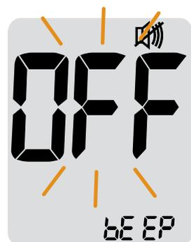
Wenn der Ton auf OFF gestellt ist, ist keine der Tonfunktionen aktiv. Drücken Sie nach der Einstellung des Tons die **S-Taste**, um mit dem nächsten Schritt fortzufahren.
